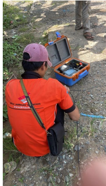
Gambar Kegiatan Teknisi LJN Melakukan Pengujian Redaman SFP yang sampai ke ODP
